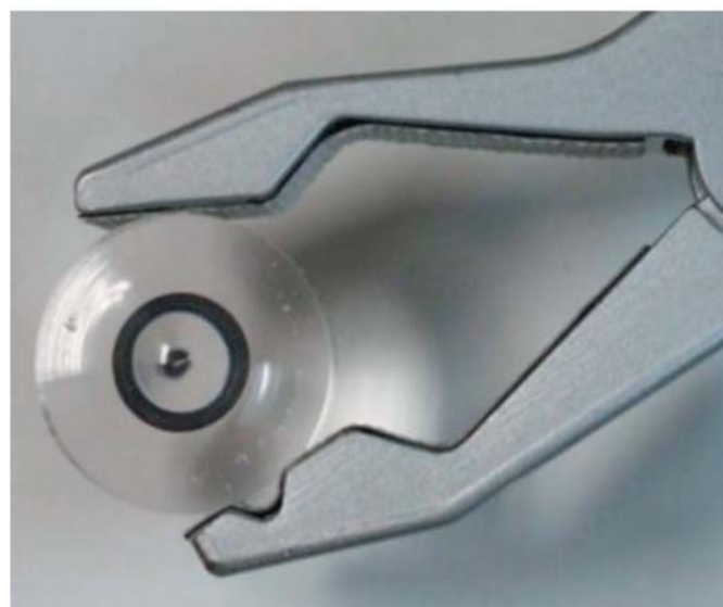
图2: CD播放机的激光头是注塑产品的一个例子。它包括精密光学透镜,直径为4mm,与模具的配合公差为千分之0.1毫米。该部件离开模具后即可用于总装配。
